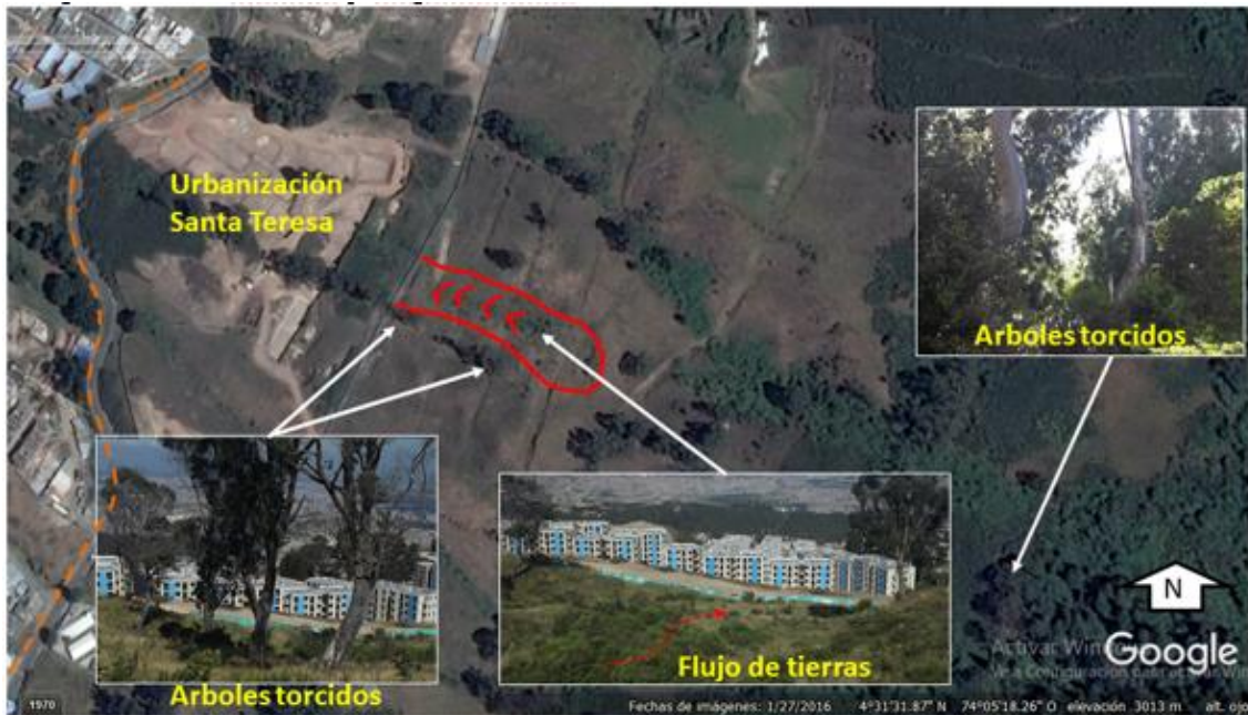
Ilustración 13 Observaciones en el terreno. La línea punteada del costado izquierdo, de manera aproximada indica la localización de la tubería a implantar (Fuente Google Earth).
